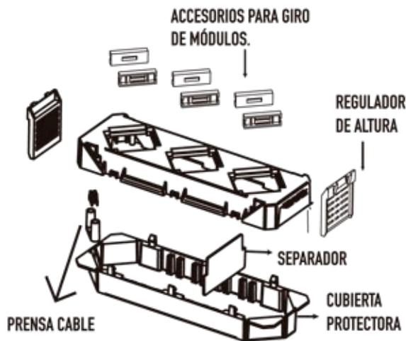
6 | INSERTAR LOS TOMACORRIENTES Y/O MÓD. DE DATOS. CABLEAR Y EMPUJAR LAS ISLAS EN LA CAJA.
